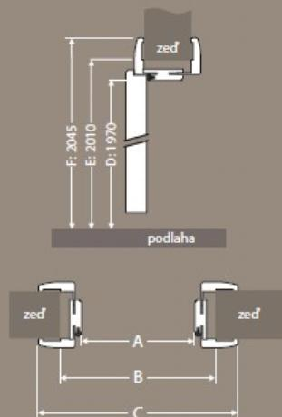
Rozměry otvorů pro obložkové zárubně se stanovují následovně:
